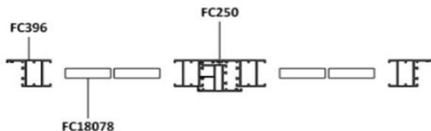
Persiana realizzata senza telaio e anta piana a quadrata sezione la rendono di notevole robustezza ma con design lineare e pulito che si adatta facilmente sia alle ristrutturazioni che alle nuove costruzioni
